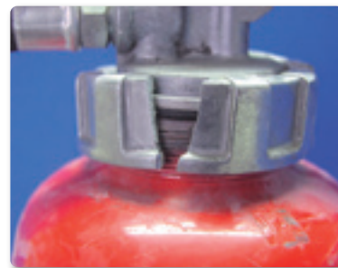
使用に耐えない破損
