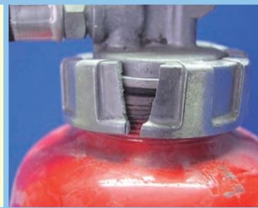
キャップの破損
