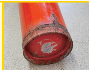
溶接部とその周辺の腐食
