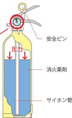
住宅用消火器は、本体容器内には消火薬剤と放射圧力源となる窒素ガスが蓄圧されています。レバーを引くと消火薬剤がノズルより放出される仕組みになっています。点検はかんたんで、ゲージの針が緑色の部分にあれば正常です。
