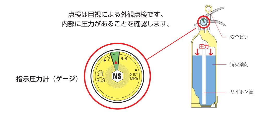
住宅用消火器は、本体容器内には消火薬剤と放射圧力源となる窒素ガスが蓄圧されています。レバーを引くと消火薬剤がノズルより放出される仕組みになっています。 点検はかんたんで、ゲージの針が緑色の部分にあれば正常です。
