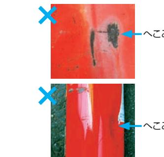
**本体の底部**：消火器の底部とその周辺に腐食がないこと。
