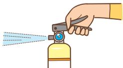
液体の消火薬剤が霧状に放射され、浸透して内部から冷却することで消火します。
